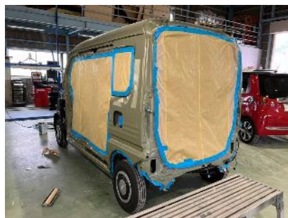
ドアやバンパーなどの車両部品を外し、外装を塗装中のmobica車両
