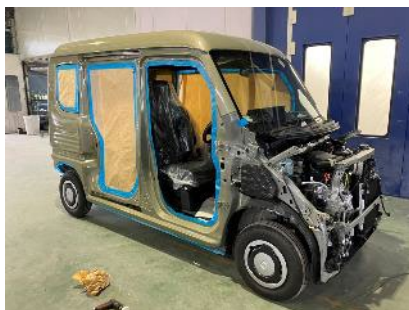
ドアやバンパーなどの車両部品を外し、外装を塗装中のmobica車両
