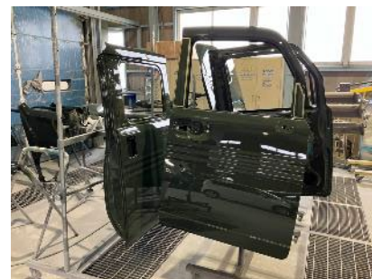
ドアやバンパーなどの車両部品を外し、外装を塗装中のmobica車両
